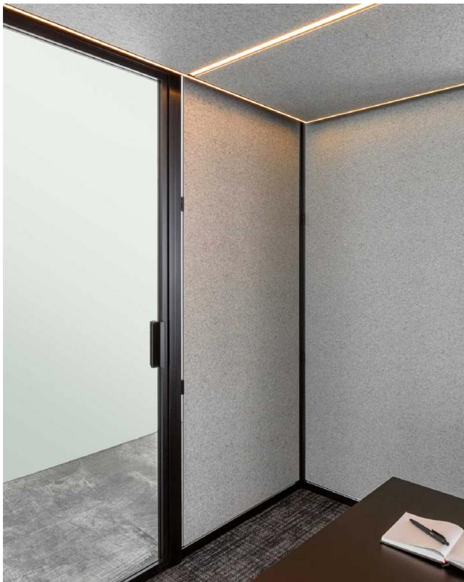
**I pannelli alti aumentano l'attenuazione sonora e attuano una chiusura totale dei settori vetrati. In base alle preferenze possono essere installati internamente o esternamente ai box massimizzando l'assorbimento acustico. La facilità di installazione consente una disposizione parziale e asimmetrica modificando la riflessione delle onde sonore e l'effetto estetico del box.**
