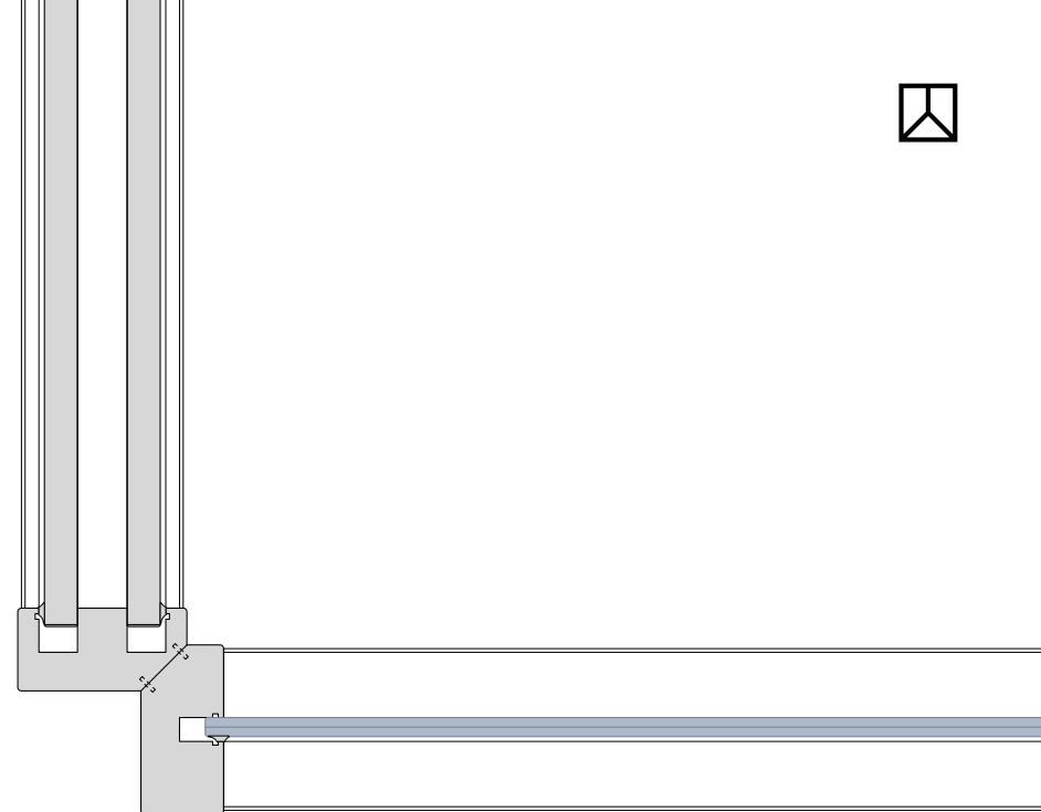
Angolo a 90° in legno cieco/vetro singolo
