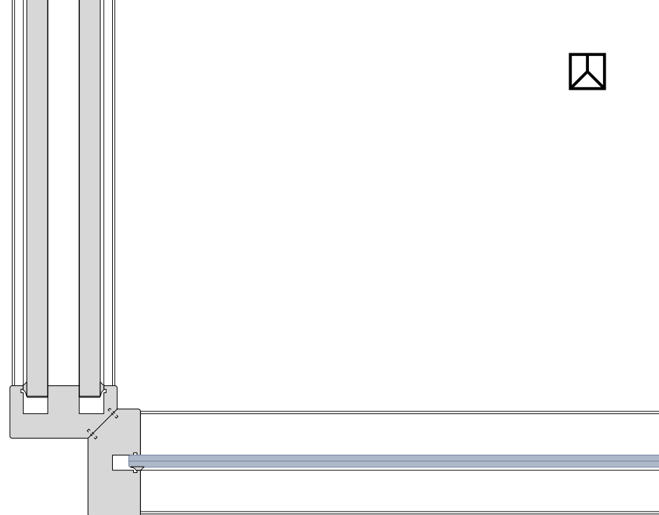
Angolo a 90° in legno cieco/vetro singolo
